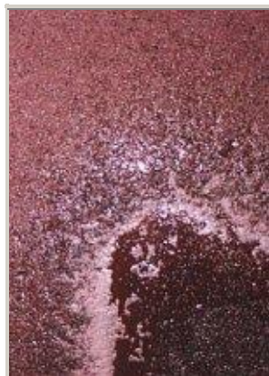
Visão do interior do tanque fermentação, mostrando o mosto em fermentação tumultuosa com a espuma resultante da liberação de CO2
