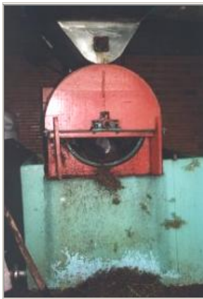
Máquina de desengaçamento em operação (esquerda) e o engaço recolhido ao final da operação
