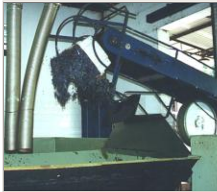
Lançamento das uvas no tanque de recepção
