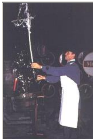
Abertura da tampa e expulsão do cilindro de sedimentos pela pressão interna
