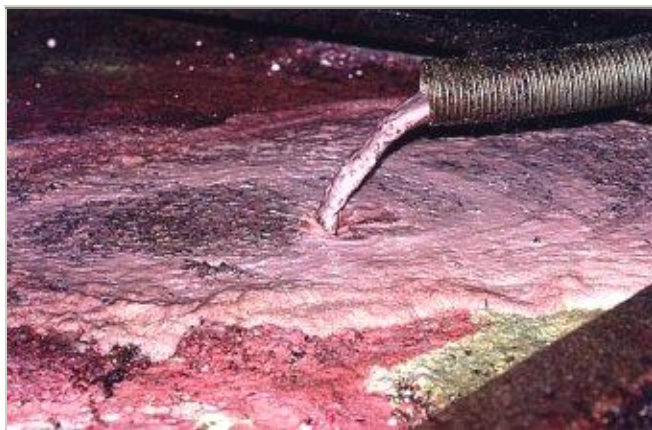
Remontagem - bombeamento do mosto do fundo do tanque para a superfície de modo a expor as cascas
