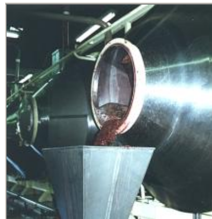
Vinimatic - tanque de aço inox que, como uma betoneira, gira
