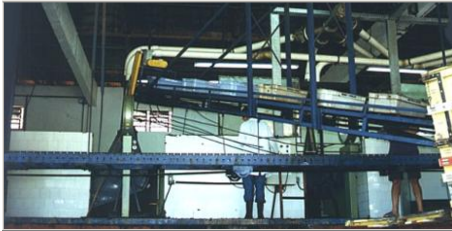
Esteira conduzindo as caixas de plástico contendo as uvas colhidas
