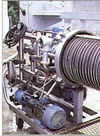
Equipamento de filtragem de diatomácea
