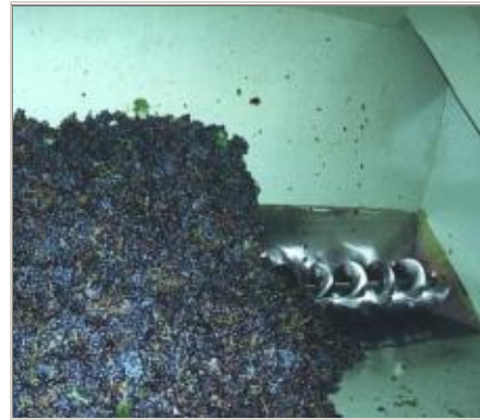
Eixo helicoidal que conduz as uvas para o desengaçador
