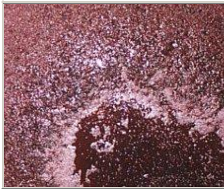
Visão do interior do tanque de fermentação de vinho tinto, mostrando o mosto em fermentação com a espuma resultante da liberação de CO 2
