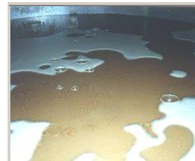
Vista interna do tanque de fermentação de vinho branco, notando-se o mosto amarelado e a espuma resultante da liberação de CO 2
