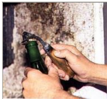
Abertura da tampa e expulsão do cilindro de sedimentos pela pressão interna
