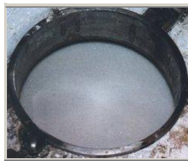
Orifício de abertura do tanque de fermentação de um vinho branco, mostrando na superfície a espuma resultante da liberação de CO 2
